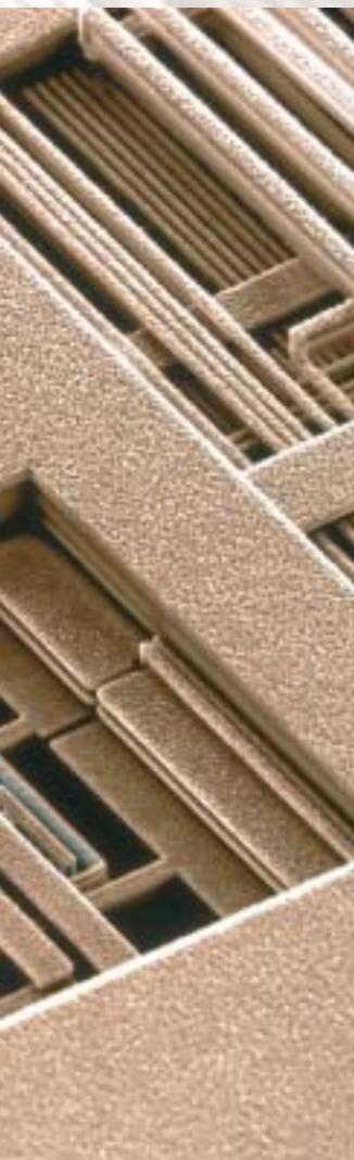
Настоящий мини-город – вытравленные медные цепи на чипе (ИВМ) под сканирующим электронным микроскопом. Современные чипы имеют до девяти уровней цепей.
