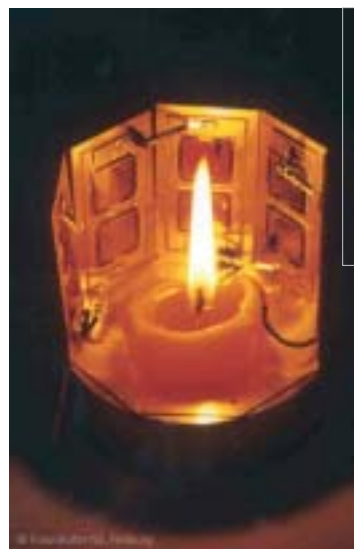
Термофотовольтаическим ячейкам достаточно света свечи для производства электроэнергии, необходимой для работы радио.
