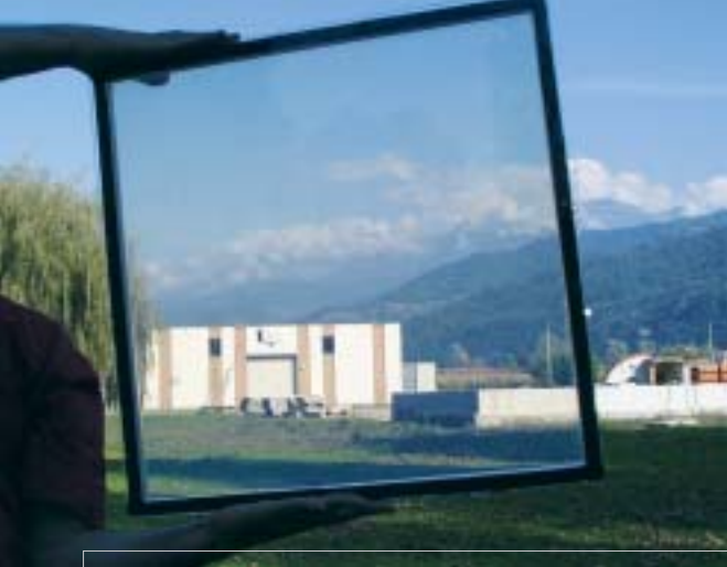
Использование аэрогеля при двойном остеклении сокращает тепловые потери.
