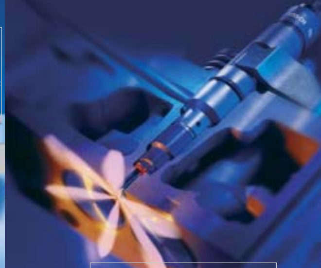
Распылительная форсунка для дизельного транспорта. В будущем на нее будут наноситься алмазоподобные слои для защиты от износа толщиной всего несколько десятков нанометров.
