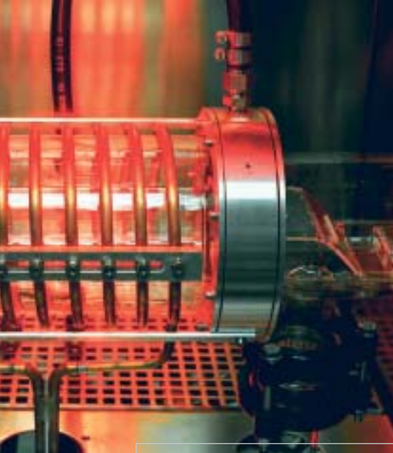
Реакторы компании Aixtron для исследований (слева) и для точного изготовления тонких слоев соединительных полупроводников (справа).
