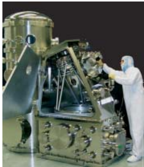
Прототип установки для экстремальной «пределной» ультрафиолетовой литографии EUV, которая будет использоваться для производства будущих поколений микросхем.
