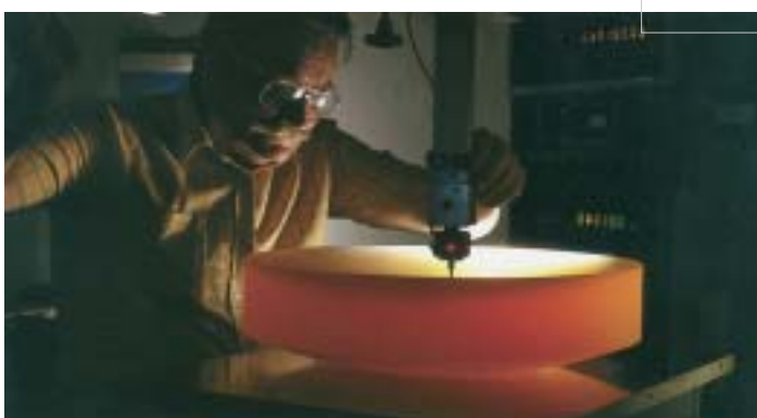
Керамика марки Церодур для шаблонов. Этот специальный вид керамики не теряет устойчивость даже в наноскопическом масштабе.
