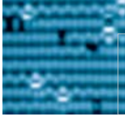
Отдельные органические молекулы на кремнии. Изображение получено с помощью сканирующего туннельного микроскопа, Рурский Университет, Бохум.
