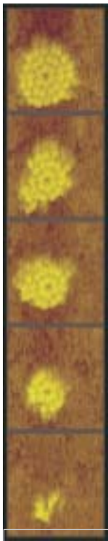
Крошечный островок кремния на кремниевом кристалле постепенно растворяется при 450 градусах. Знание этого процесса важно для обеспечения качества тонких кремниевых слоев.
